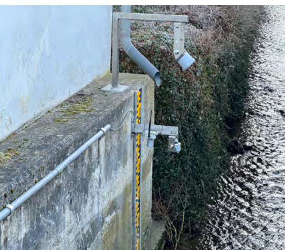
📷 Beispielhafter Wasserstandpegel in Hohenlimburg an der Lenne, ein Nebenfluss der Ruhr. Auf dieser Skala kann der Wasserstand sowohl manuell als auch elektronisch abgelesen werden. Der Wasserstand wird in Zentimeter über einem festen Referenzpunkt angezeigt. Die Sensoren sind druck- oder ultraschallbetrieben. Ohne Strom muss manuell von der gelb-schwarzen Skala abgelesen werden.
